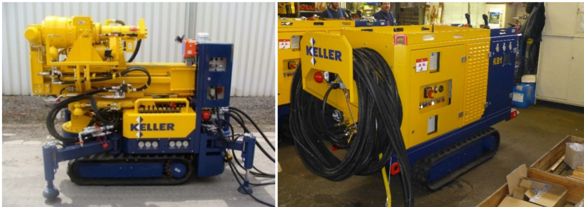
Figura 8. Maquinaria base para la ejecución de Jetgrouting en zonas de pequeño gálibo (2,25 m, aprox.).
