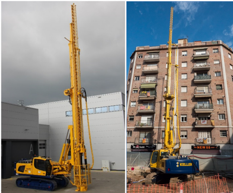
Figura 7. Maquinaria base para la ejecución de Jet Grouting hasta grandes profundidades (60 a 70 m, aprox.), proyecto Keller Barcelona.
